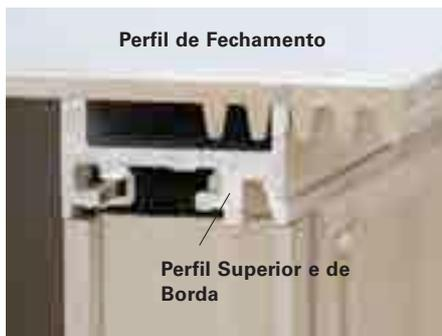
Os dentes dos Perfis de Fechamento devem ser totalmente encaixados no Perfil Superior e Perfil de Borda.
